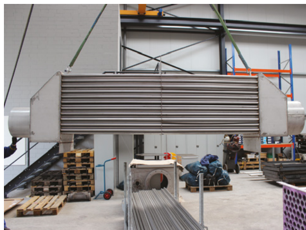
Bild 2: Zur Sanierung gehört auch der Wärmetauscher für den Stoßofen.
